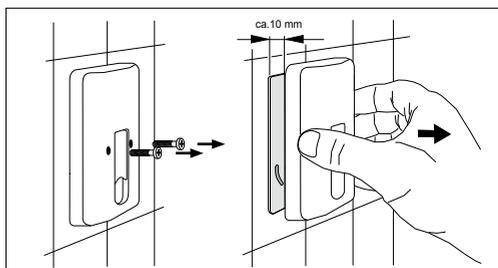
Abbildung 4: Lösen der Schrauben von dem Oberteil (Darstellung der Unterputzausführung)
