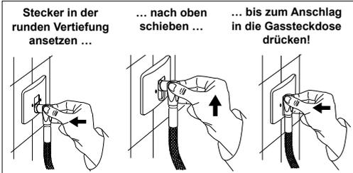
Abbildung 1: Bedienung der Gassteckdose PLUG1 (Darstellung der Unterputzausführung)
