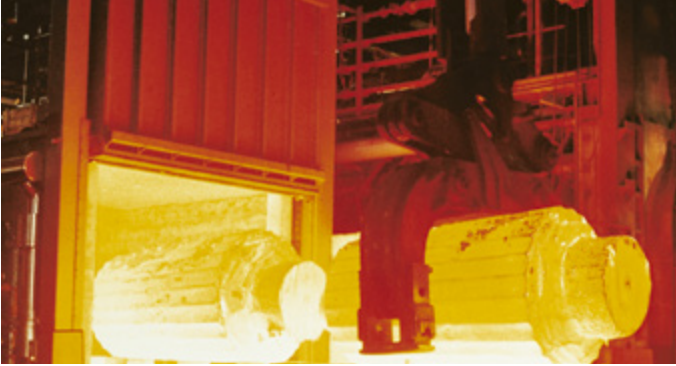
Wagenherd-Schmeldeofen in der Metallindustrie
