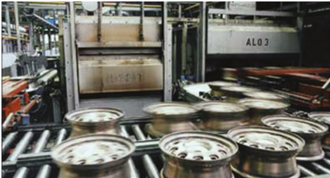
Aluminiumindustrie: Aushärtungsöfen für Felgen
