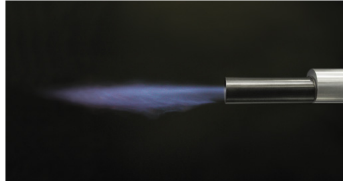
Flamme des ZKIH bei Erdgasbetrieb im Freibrand
